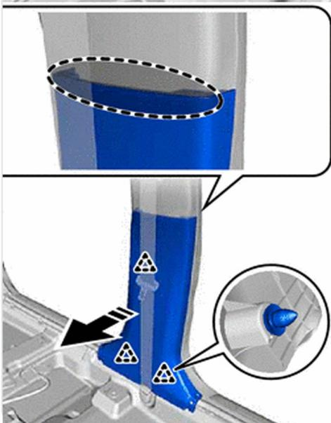
**10** Снимите облицовочную накладку средней стойки кузова
