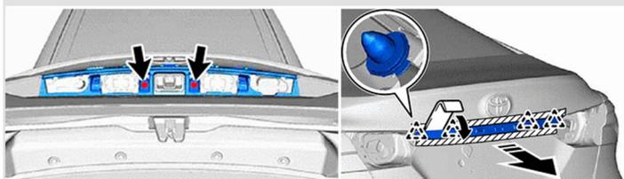
**6** Освободите 2 захвата и снимите заднюю камеру в сборе, отсоедините разъем.
