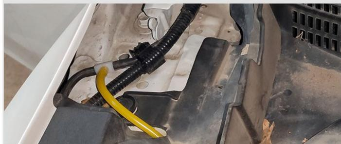
**14** Проложите шланг от тройника через штатный уплотнитель моторного отсека, далее по порогу к крышке багажника.
