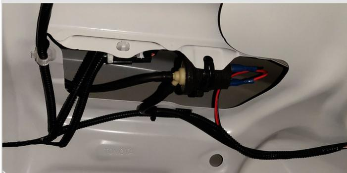
**17** Подключите провода электромагнитного клапана к лампе заднего хода на правом фонаре (полярность подключения значения не имеет).
