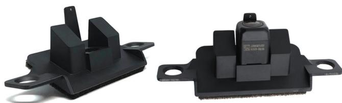
**8** Установите камеру с кронштейном в штатное место и, придерживая изнутри. Прижмите её наружной накладкой двери багажного отделения. Заверните 2 винта и установите нижнюю наружную накладку двери багажного отделения.
