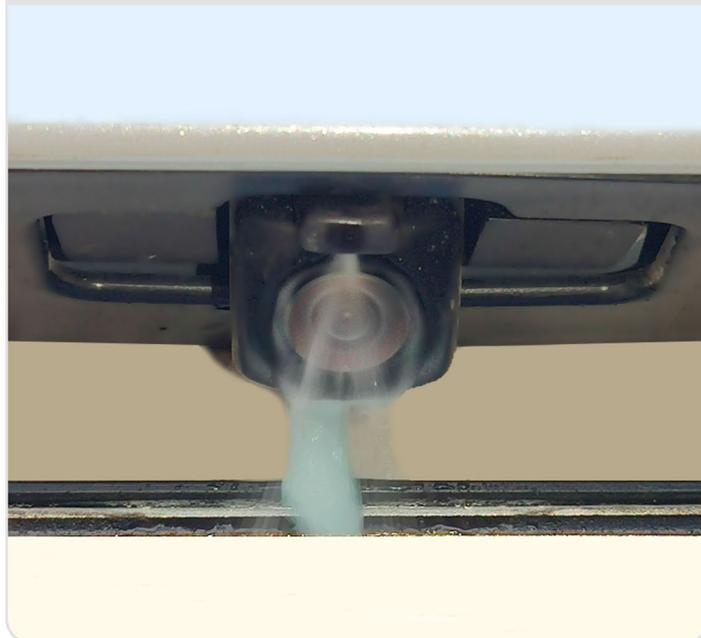
**16** При подключении омывателя по схеме с электромагнитным клапан (постается отдельно), установите его в разрыв шланга, ближе к обратному клапану. Закрепите электромагнитный клапан на крышке багажника с помощью пластиковых стяжек. Возможное место показано на фото.
