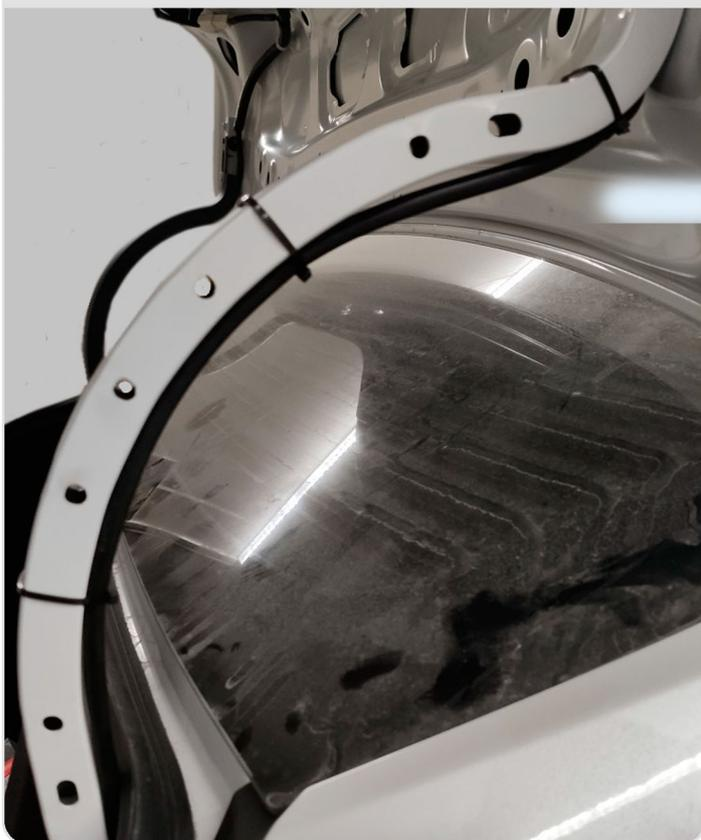
**18** Включите омыватель лобового стекла (и заднюю передачу если ваш комплект с электромагнитным клапаном), убедитесь в отсутствии течей. Сборка авто осуществляется в обратной последовательности (при сборке убедитесь, что устанавливаемые накладки не пережимают шланг подачи жидкости к омывателю камеры).
