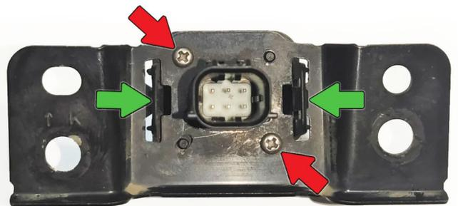
**6** Наденьте колпачок нового кронштейна на камеру и соберите две половинки кронштейна. Закрутите винты камеры к новому кронштейну.
