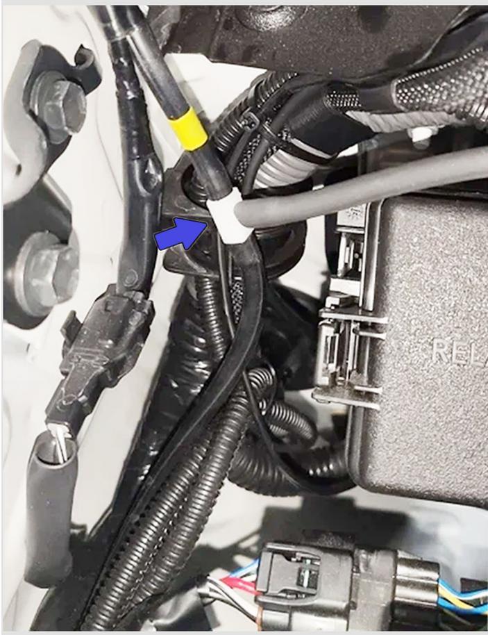
**9** Протяните шланг от тройника к передней камере, закрепите его стяжками на штатной проводке.
