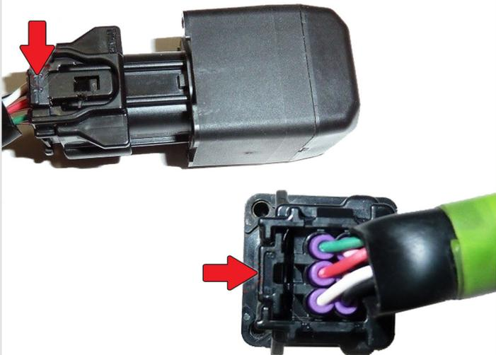
**3** Отсоедините **разъём** подключения камеры.
