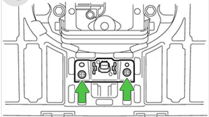
**5** Отверните **винты** крепления камеры к штатному кронштейну, освободите **2 фиксатора** колпачка и снимите камеру с кронштейна.
