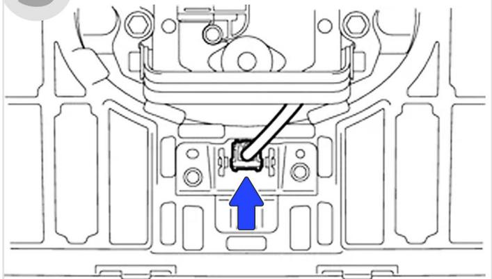
**4** Выверните **2 винта** и снимите переднюю камеру с кронштейном.
