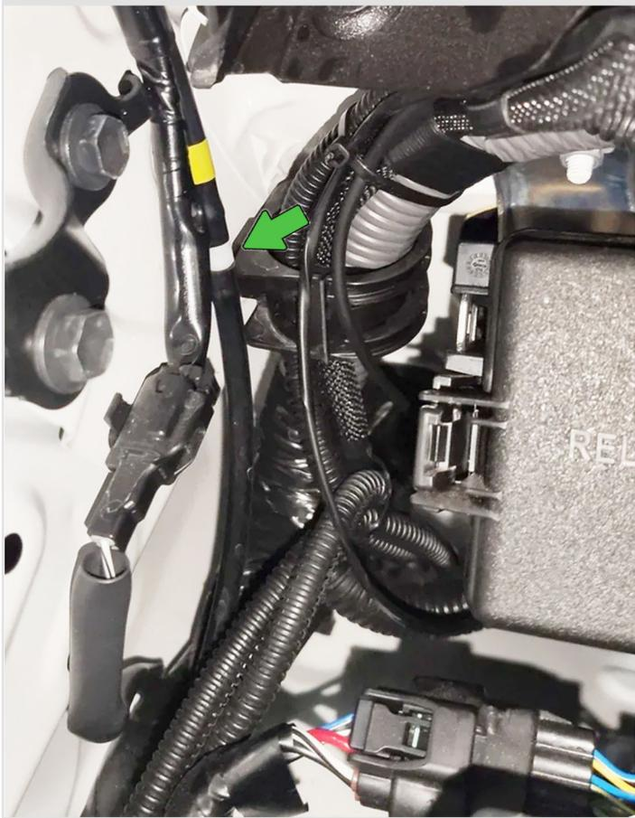
**8** Замените штатный соединитель шланга омывателя на **тройник** из комплекта.
