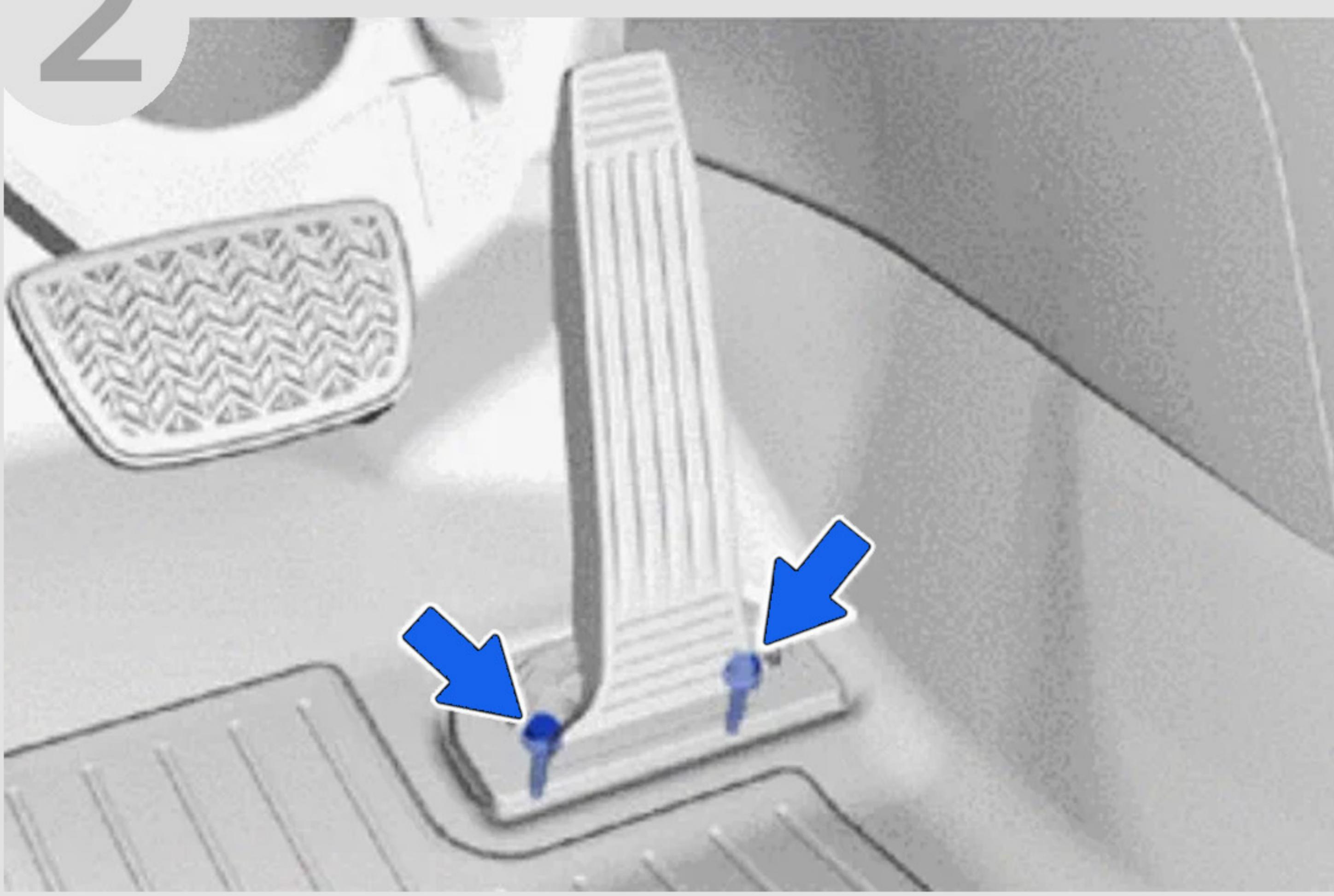
3 Отсоедините крепление педали от пола и снимите накладку с рычага акселератора.
