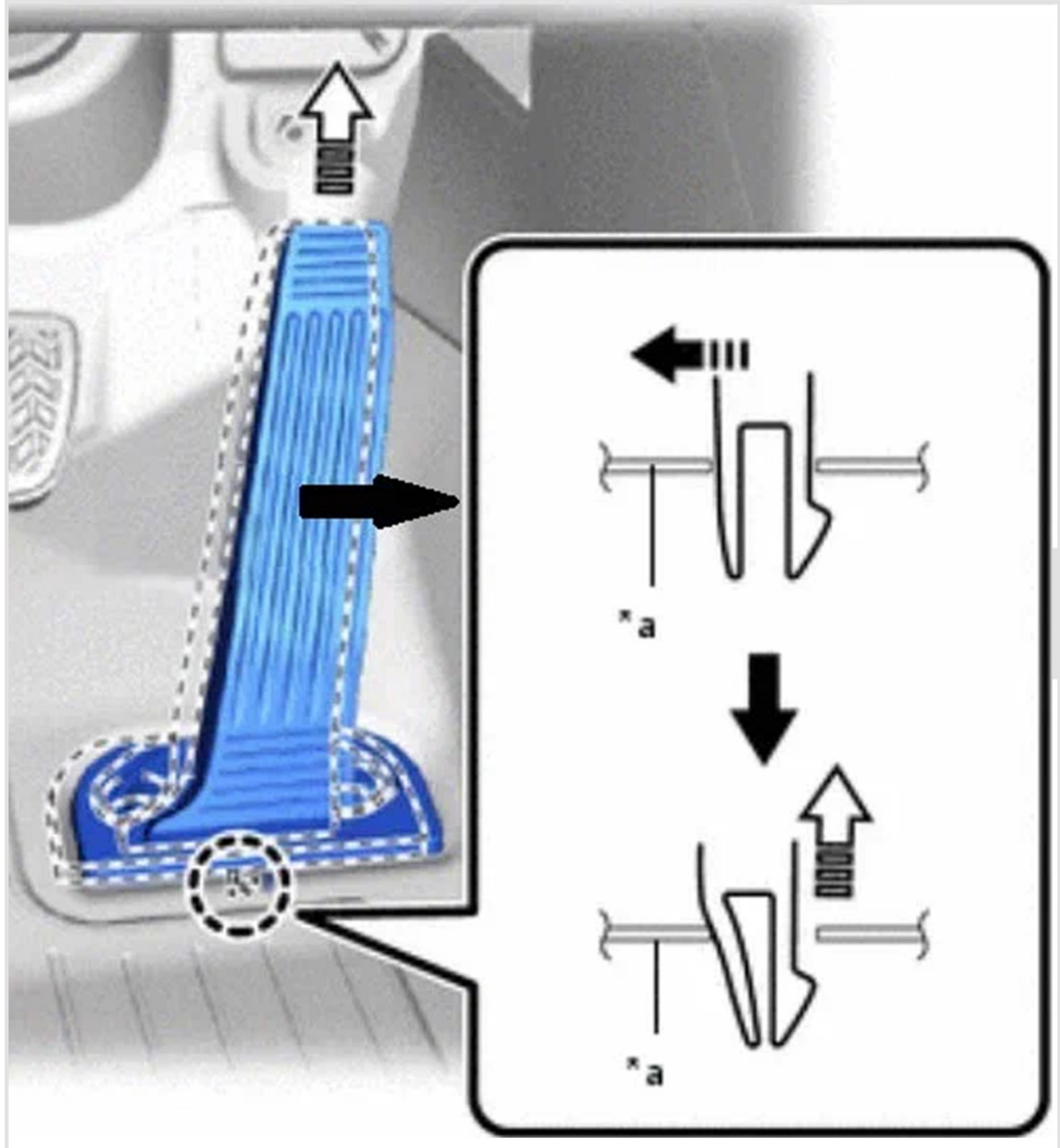
4 Установите новую накладку на рычаг акселератора, закрепите ее стяжкой.
