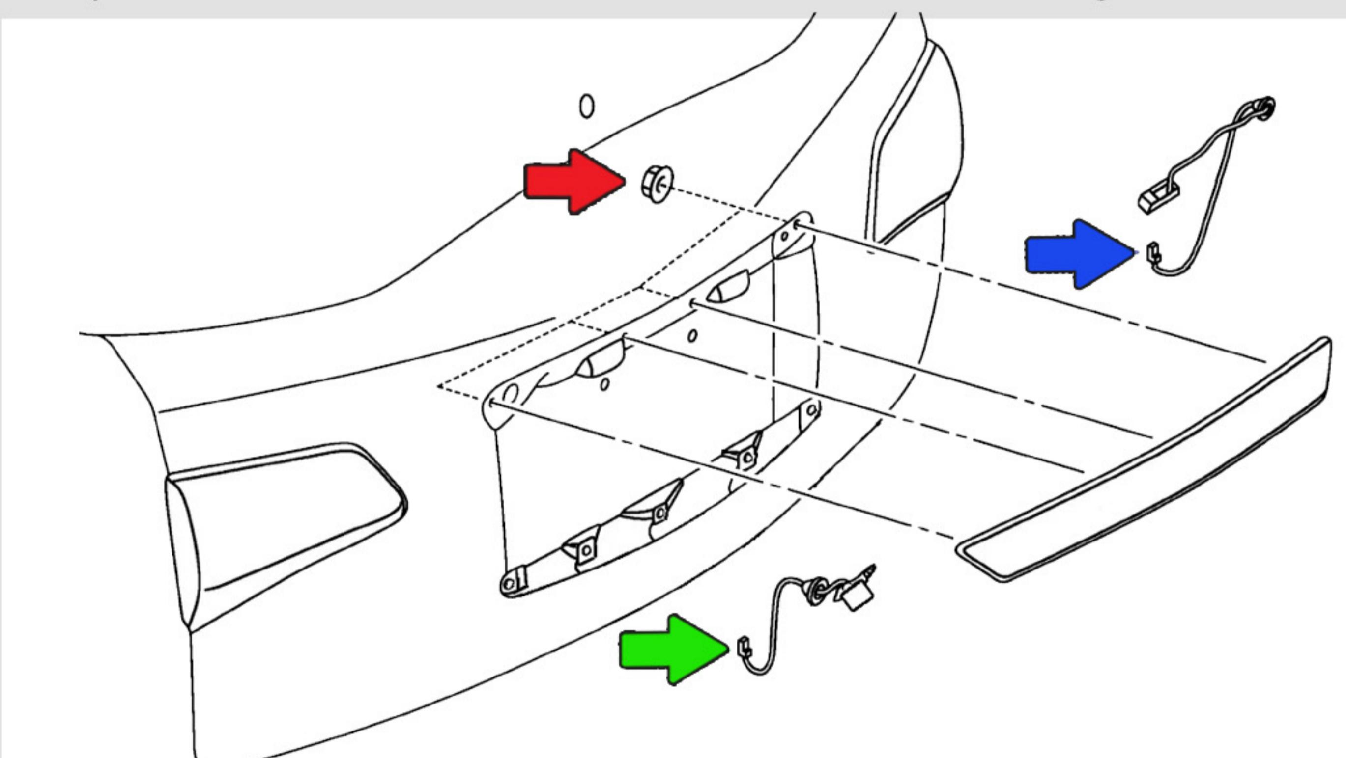
**5** Открутите **винты** крепления штатного кронштейна к наружной планке. Открутите **винты** крепления провода к камере и снимите его. Открутите **винты** крепления камеры к кронштейну.
