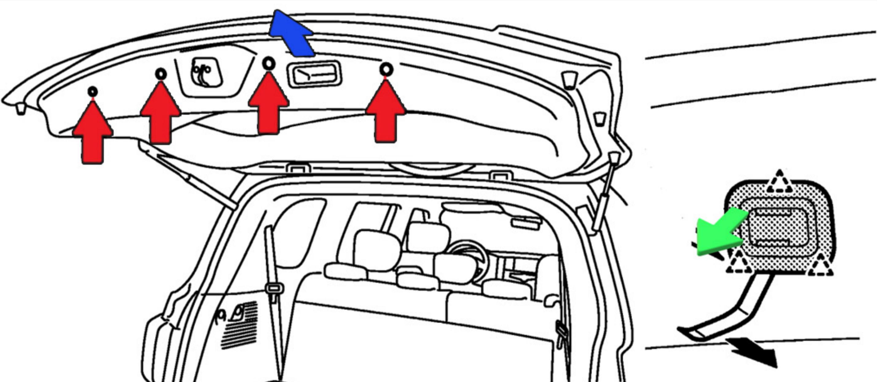
**2** Снимите центральную облицовку крышки багажного отделения.
