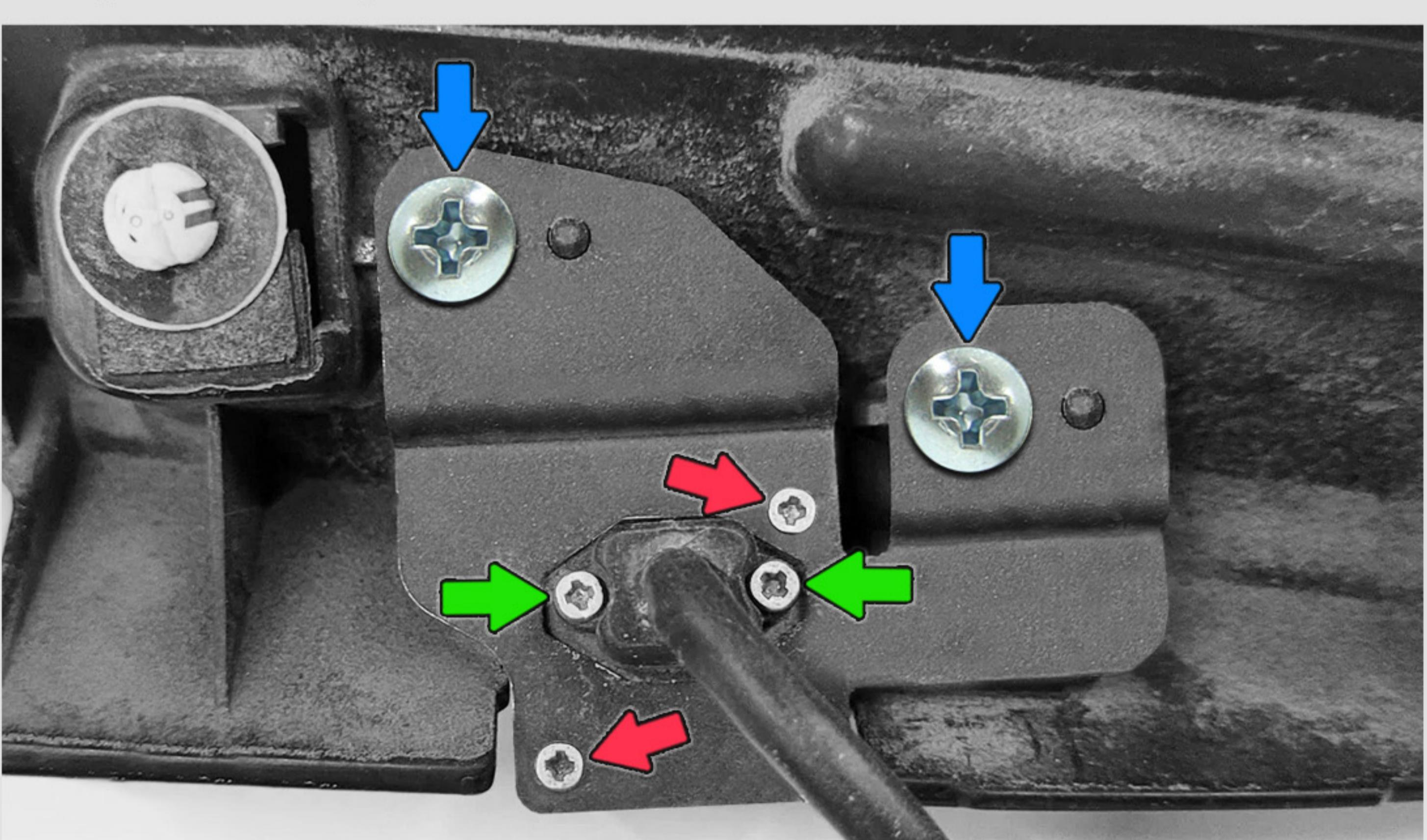
**6** Установите камеру на новый кронштейн. Закрутите **винты** крепления. Присоедините провод и закрутите **винты** его крепления.
