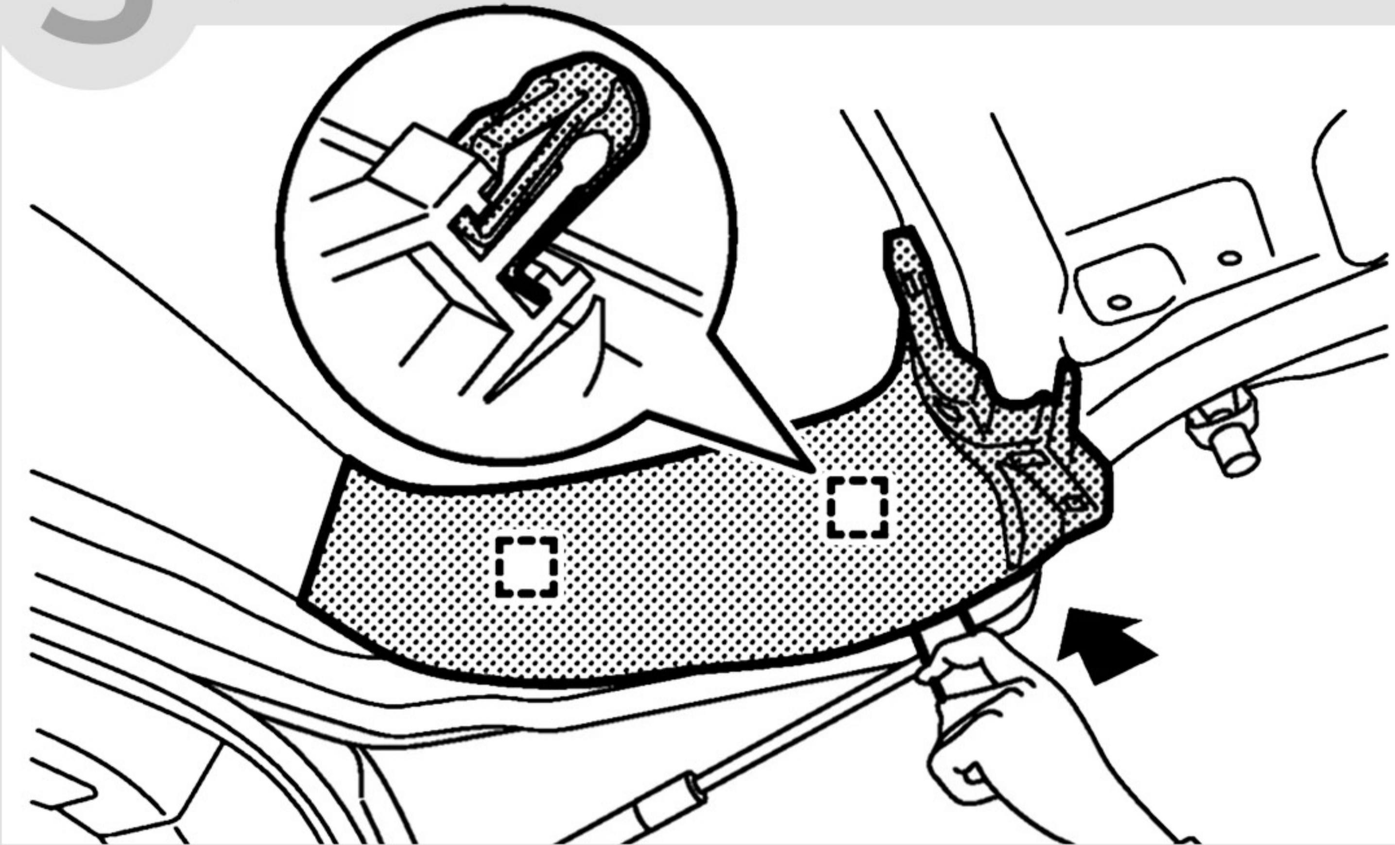
**4** Открутите **4 гайки** 8 мм крепления наружной планки крышки багажного отделения, отсоедините разъемы **камеры** и **кнопки** открывания багажника. Снимите планку.
